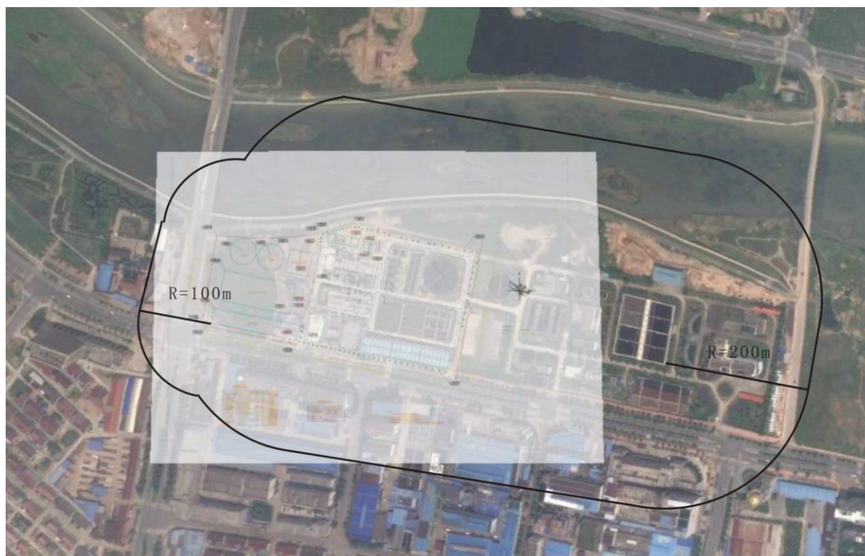
图 3-1 全厂卫生防护距离包络线示意图
