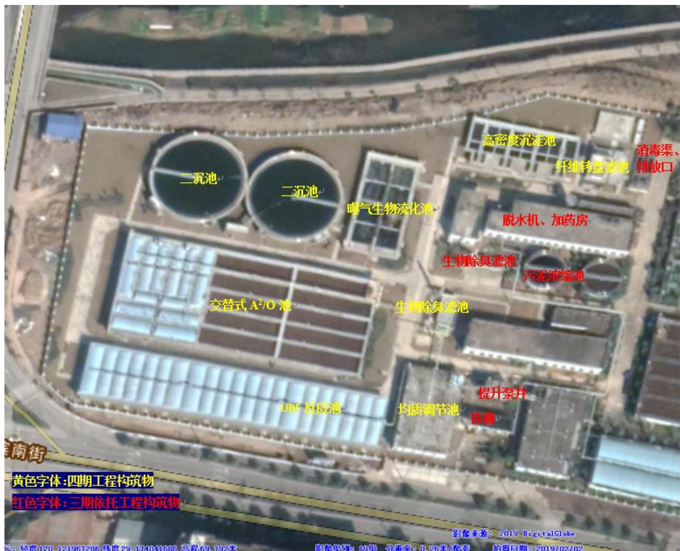
图 2-1 四期工程平面布置示意图
